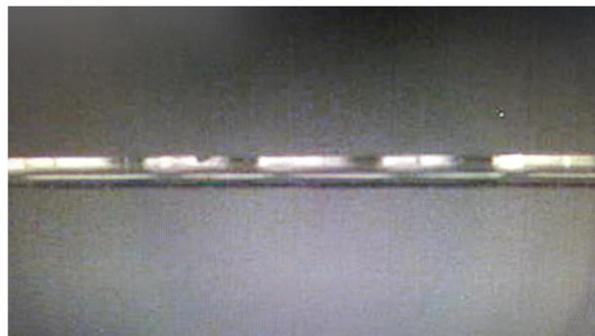
Figura 10. Fotografía de una fibra óptica conteniendo una LPG.
