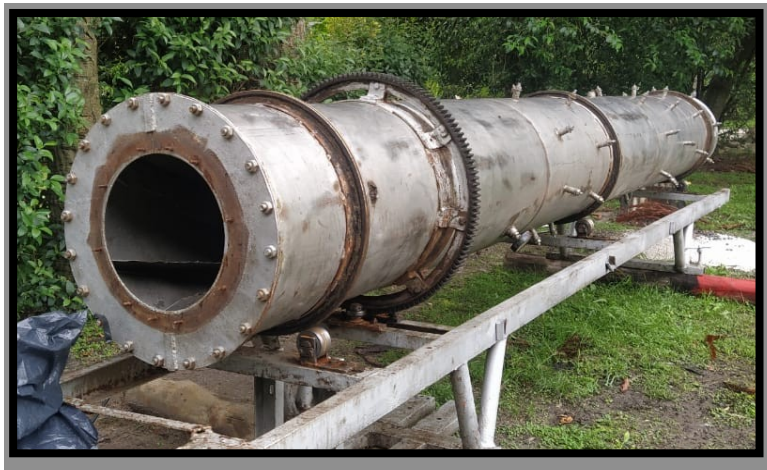
Imagen 1. Horno rotatorio de acero inoxidable, montado sobre rodillos y chasis. Elaboración propia
