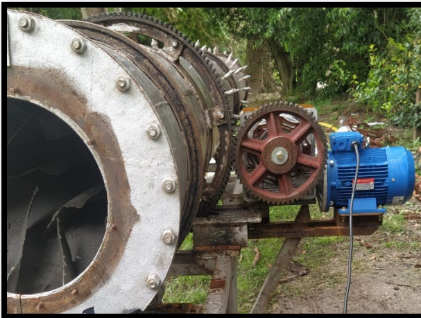
Imagen 2. Motor instalado en el chasis con engranaje reductor de transmisión y tolva de carga. Elaboración propia.
