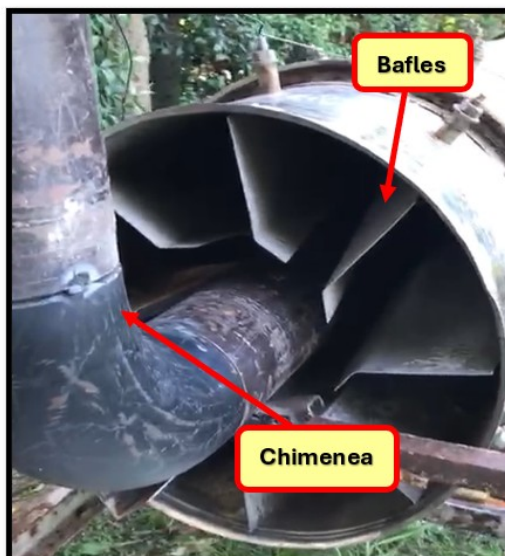
Imagen 3. Vista de la cámara de combustión y tubo de escape de gases del horno rotativo . Elaboración propia
