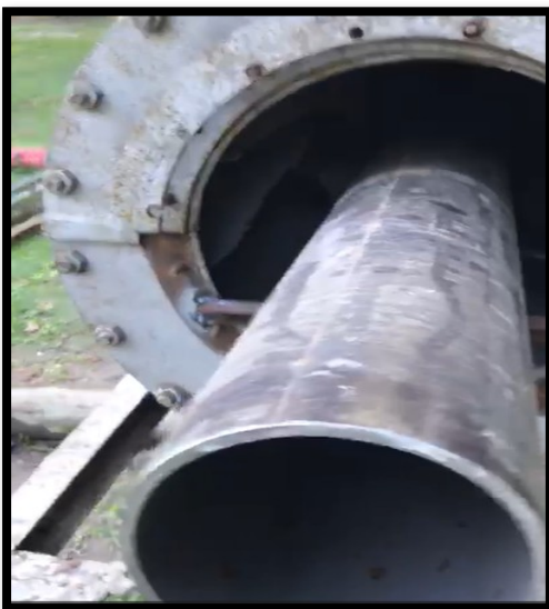
Imagen 3. Vista de la cámara de combustión y tubo de escape de gases del horno rotativo . Elaboración propia
