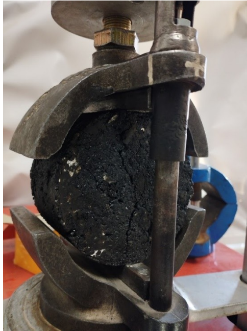
Figura 4: Probeta en ensayo a tracción indirecta con mordaza adaptada con fleje. (Fuente: Propia)
