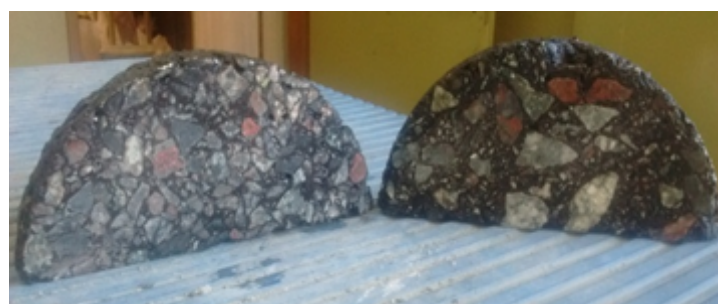
FIGURA 20 Diferencia granulométrica evidenciada en probetas exteriores.
