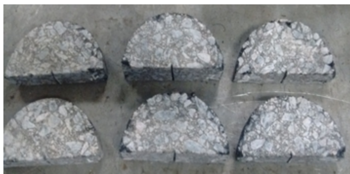
FIGURA 19 Distribución de áridos probetas centrales.
