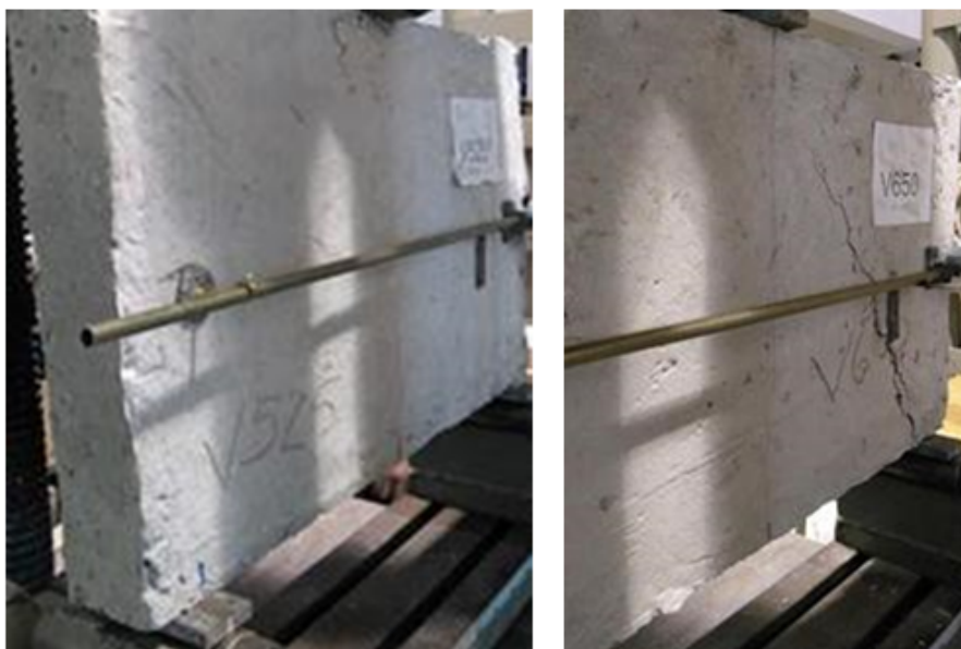
FIGURA 3B Modos de falla: vigas de HRFA
