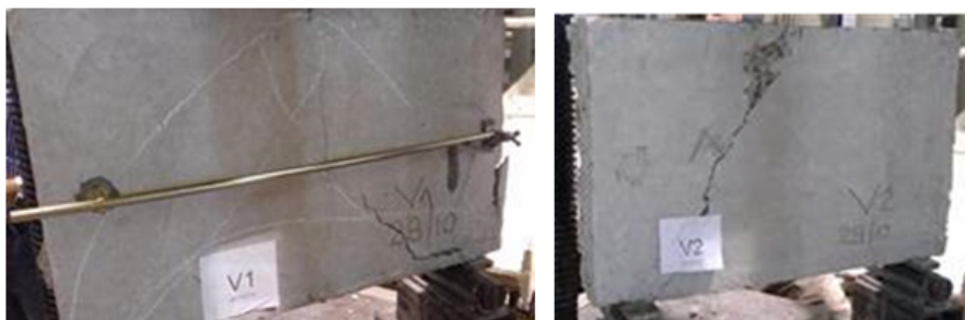
FIGURA 3A Modos de falla: vigas de hormigón sin fibras
