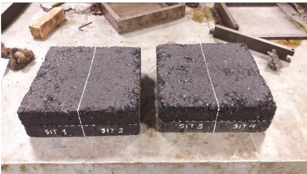
Figura 10. Probetas dobles prismáticas moldeadas
