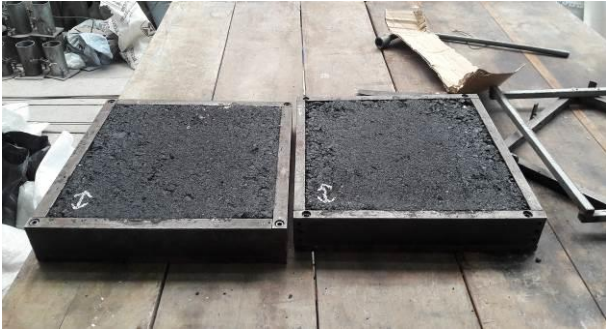
Figura 8. Bases para las probetas moldeadas con Roller Compact
