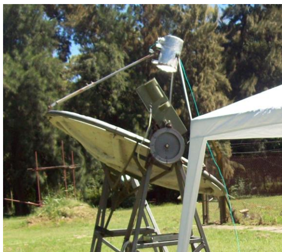
Figura 9. Colector alineado, con el calorímetro a 0,87 m de su ápice, durante la realización de las experiencias.
